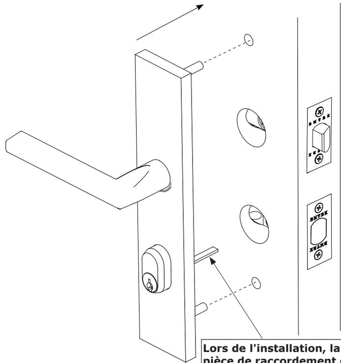
**Lors de l'installation, la pièce de raccordement doit être en position horizontale.**
